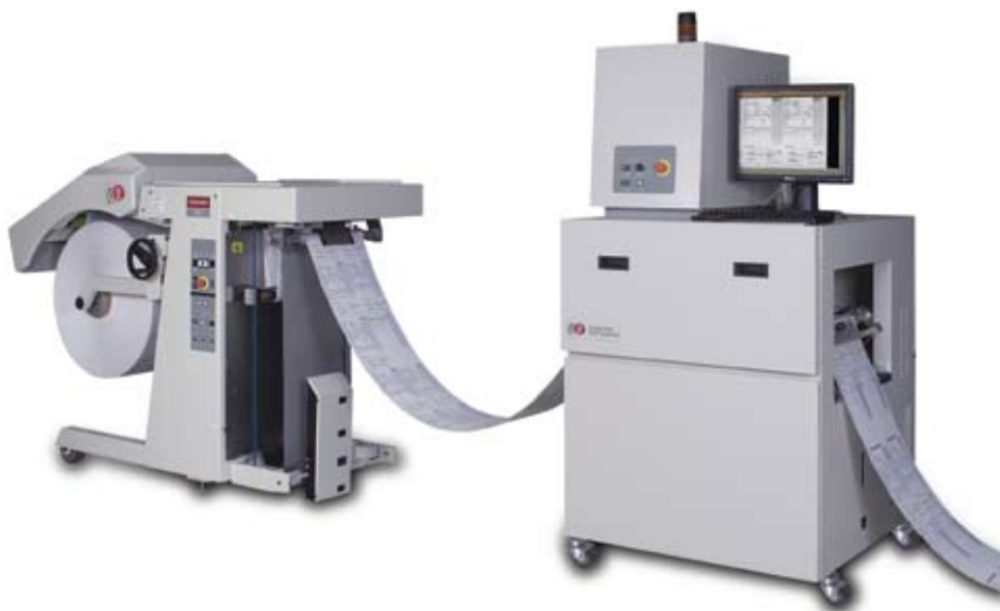
Web Vision comprend un module de manipulation de papier avec des caméras, un ordinateur et un écran haute résolution. (représenté ici avec le RS Rewind.)
